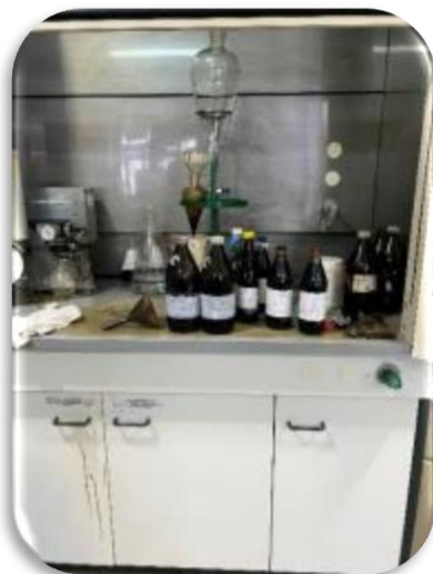
Открыта створка ВШ Открыты пробы нефти Замазучен ВШ Беспорядок на рабочем месте
